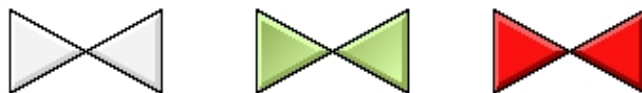
Fig Stängd ventil till vänster, öppen ventil i mitten och felsignal till höger
